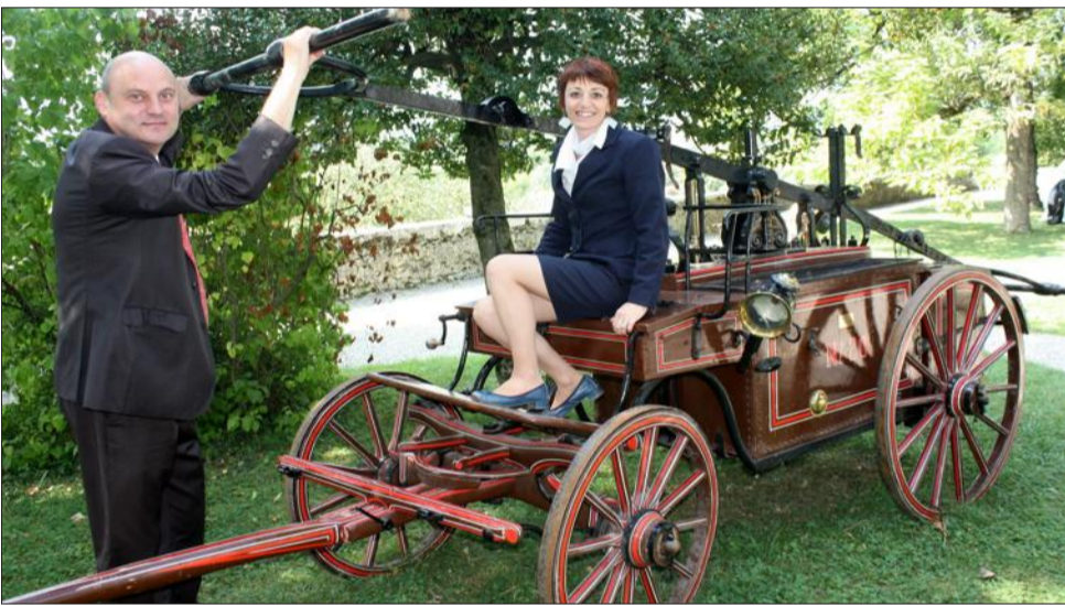
Franck et Barbara présentent la pompe à bras construite par les ateliers Auguste Loizeau à Bourg, en 1890. De type foulante, sa portée était de 35 mètres et sa cuve contenait 450 litres. Après l'avoir utilisée pour le mariage de sa fille, son propriétaire, monsieur de Corbière, en a fait don à la commune de Bourdeau.
