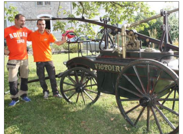
Jimi et Ansar avec la pompe à bras "La Victoire" de 1857, présentant une cuve de 460 litres et une portée de 51 mètres. Cette pompe à bras de type foulante était la propriété de Saint-Alban-Leysse. Photo Le D.U.G. JACQUEMARD
